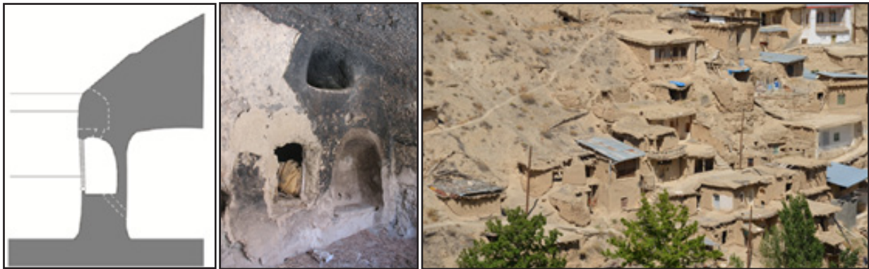
طرح ۴. مقطع شماتیک از سیلوی دست کند (طرح از: نگارنده)
